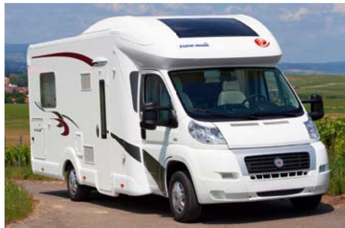
Der neue Profila RS präsentiert sich in einem modernen Karosserieverbund aus Glasfaser verstärktem Kunststoff.
