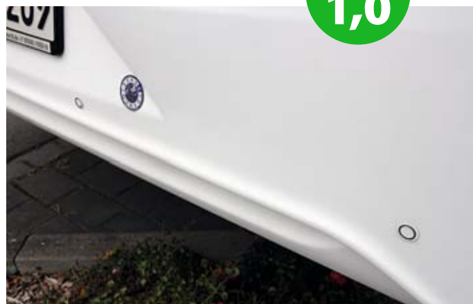
Die Einparksensoren von Caratec haben einen Durchmesser von 17 Millimetern und werden in der Front- oder Heckschürze eingebaut.
