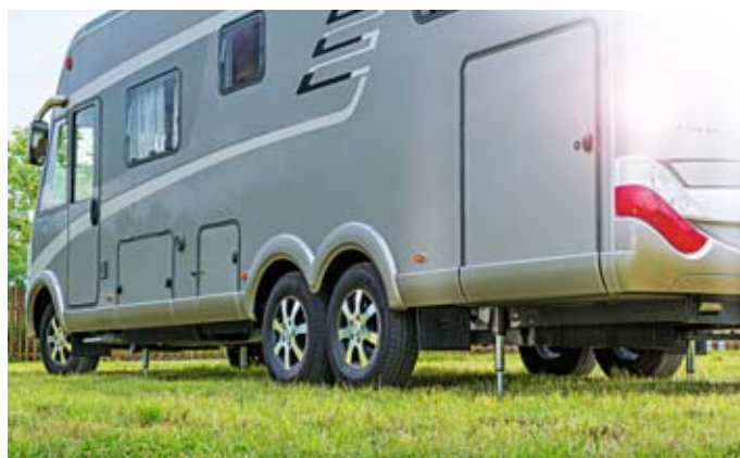
Ebene Ausrichtung auch bei unebenem Untergrund: Hubstützen machen es möglich.
