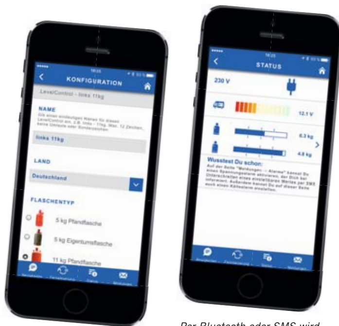
Per Bluetooth oder SMS wird auf das Display übertragen, wieviel Gas sich in den Flaschen befindet.
