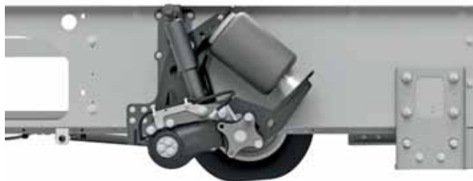
So sieht die neue Goldschmitt-Vollluftfederung für die Hinterachse der Hymer-B-Klasse aus.
