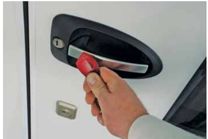
Die Tür der neuen Hymer-B-Klasse kann per RFID-Chip geöffnet werden.
