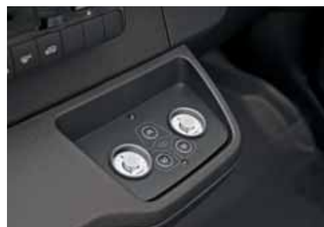
So sieht die neue Goldschmitt-Vollluftfederung für die Hinterachse der Hymer-B-Klasse aus.
